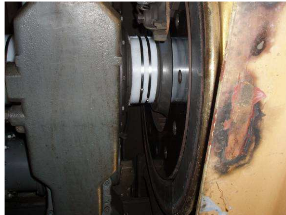
Bild 4. Kort skydd mellan växel och hjul
