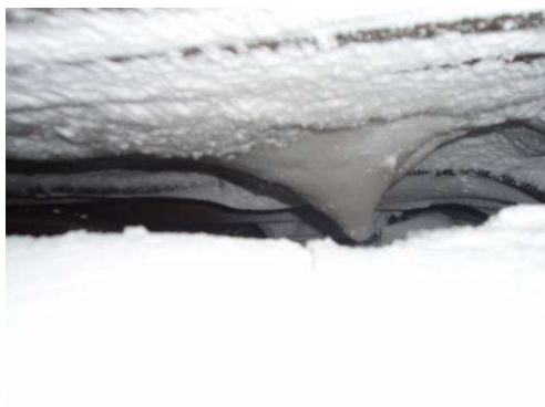
8. Is i korgunderrede, byggs upp av bromssprut
