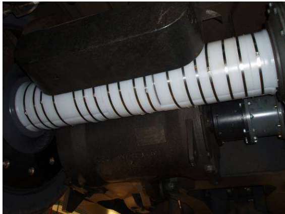
Bild 3. Långt skydd mellan hjul och växel
